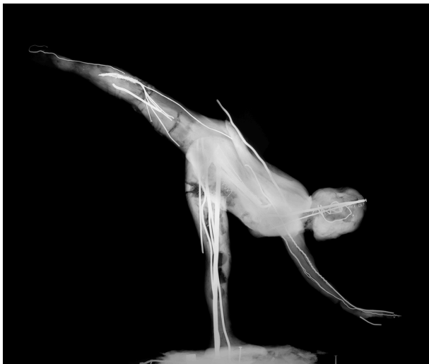
Fig. 3. X-radiograph of Fig. 2. © Centre de Recherche et de Restauration des Musées de France, Paris
